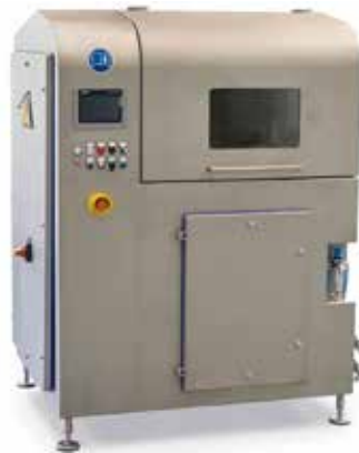
En PEF pilot enhet designet for flytende, semi-flytende og faste matprodukter
